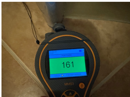
Fuktsøk ved dusjsone
