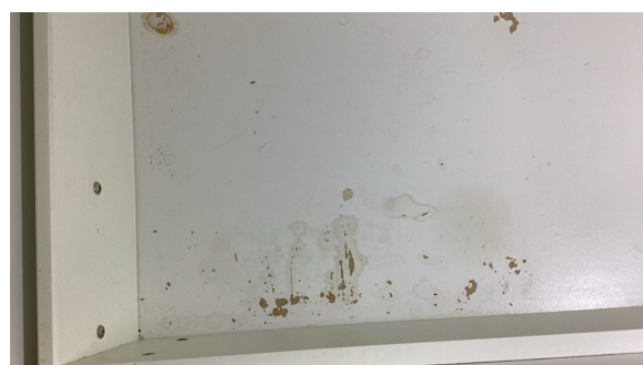
Fuktskader/svellinger i skuffebunn
