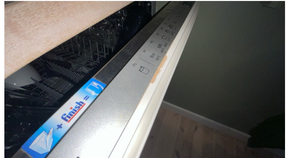
Avskalling front oppvaskmaskin.
