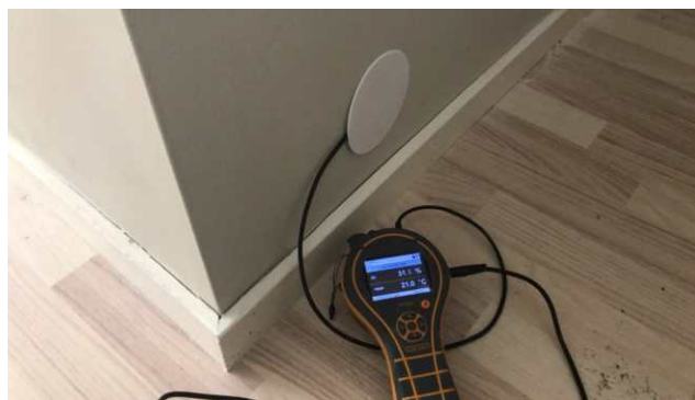
Bilde viser måling av luftfuktighet (RF)
