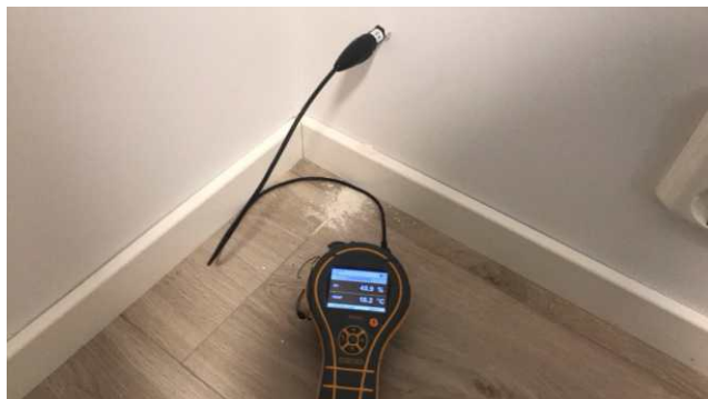
Bildet viser måling av luftfuktighet (RF).
